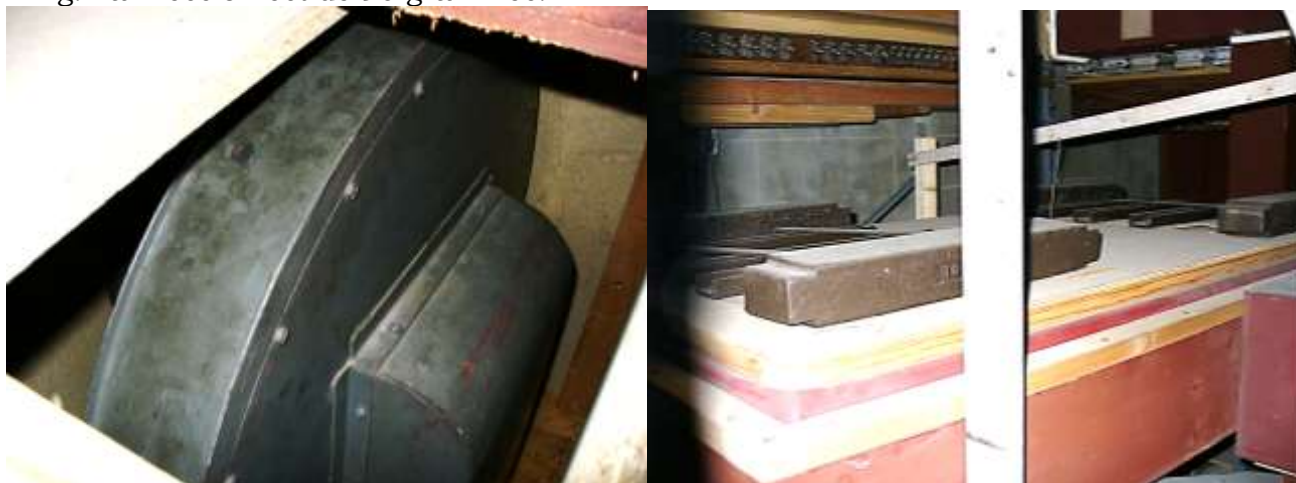
Le ventilateur à gauche et le réservoir d'air à droite
