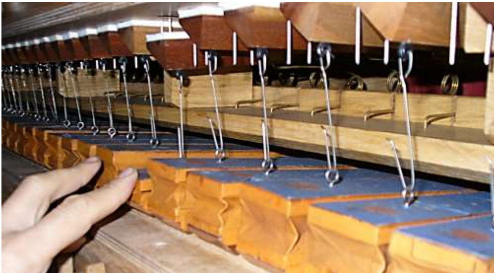
Système pneumatique d'ouverture des soupapes. On voit le petit soufflet (moteur pneumatique) abaissé qui ouvre la soupape au-dessus.
