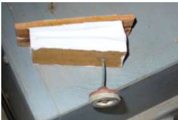
Un soufflet moteur réparé avec du polypel
